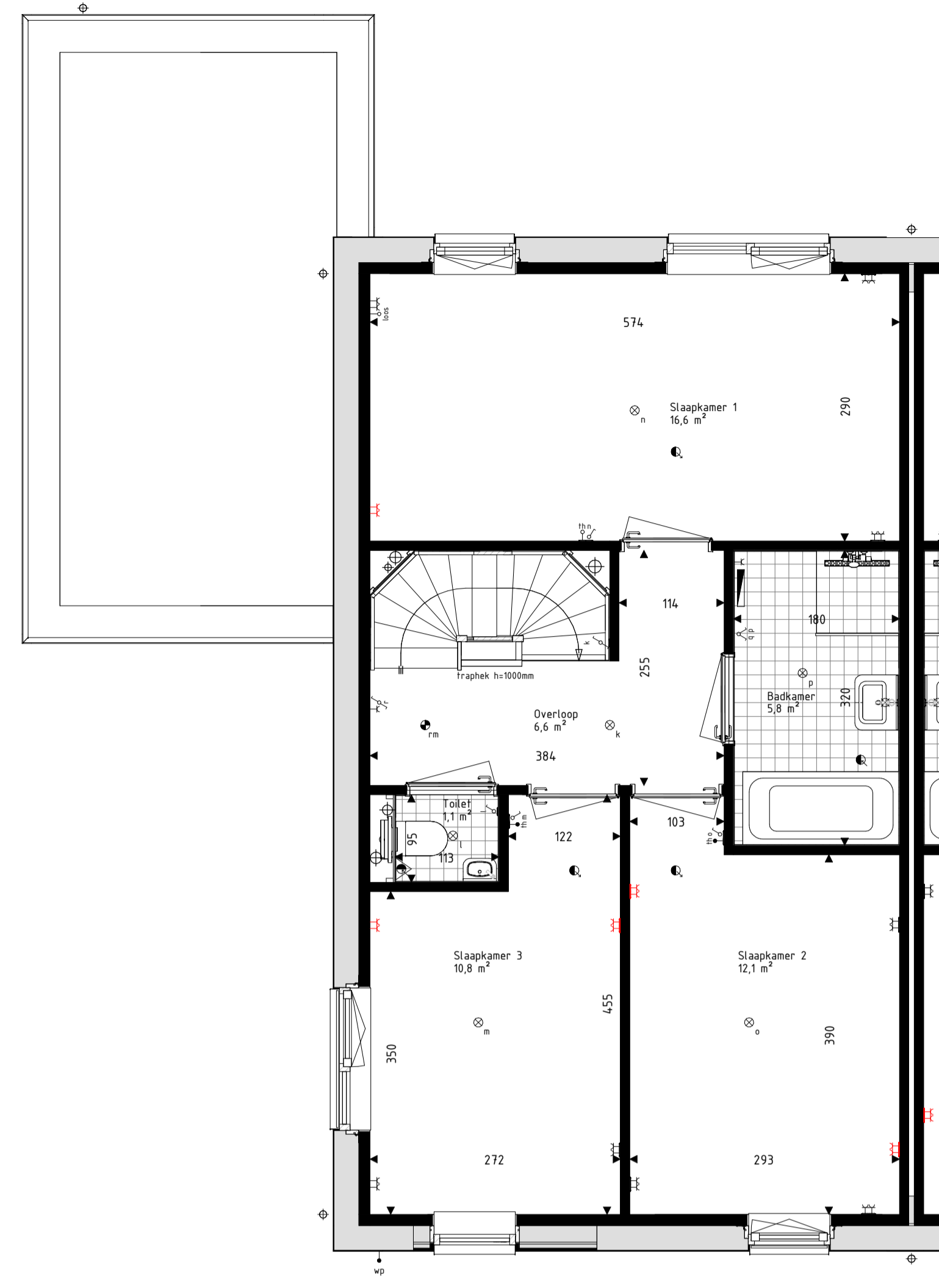
Eerste verdieping schaal: 1 : 50
